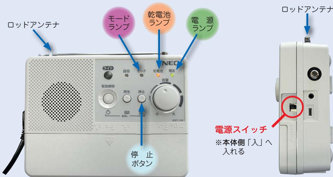
③ 機器前面の「モードランプ」が、赤または**オレンジ色**になっている場合、消音設定になっていますので「停止ボタン」を長押しすると解除できます。
